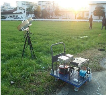
SODAR の開発：音響パルスを発射して上空の風速を計測する
