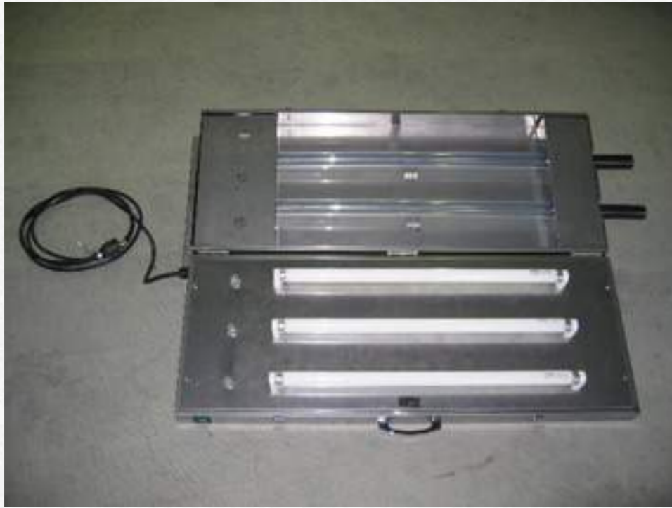
図4-30 光触媒式病害防除装置「すこや花」
