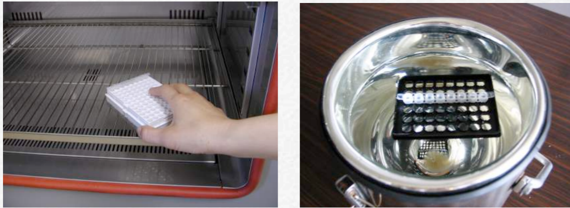
図3-46 反応チューブを恒温器や保温性の高いジャーなどで保温
