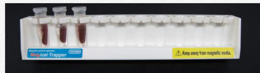
図3-65 マグネチックスタンド (Magical Trapper™) 東洋紡 MGS-101
