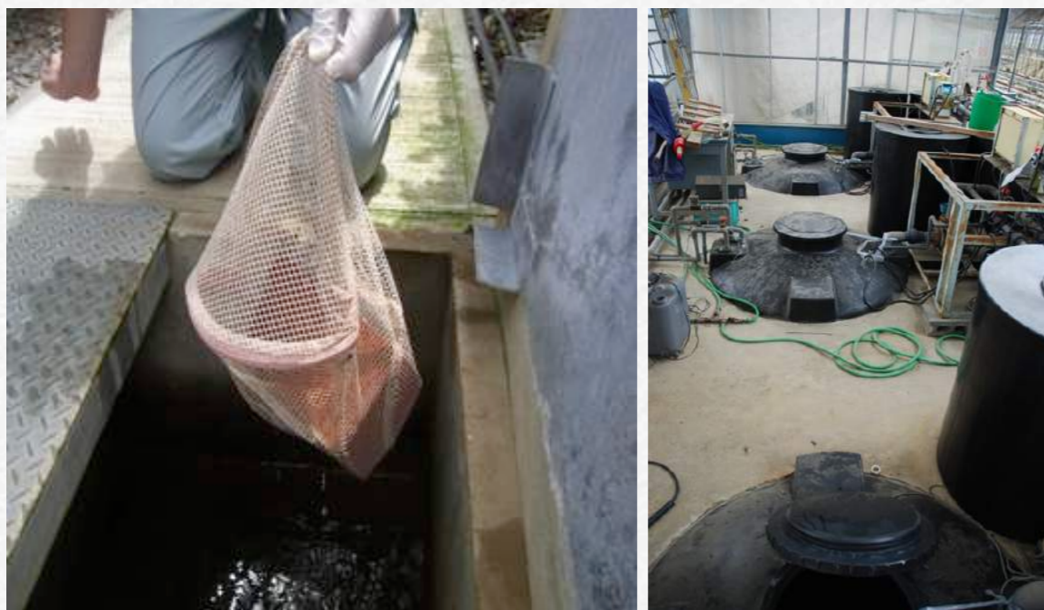
図3-18 循環タンク内に設置（煉瓦を入れて流されにくくしている例）
