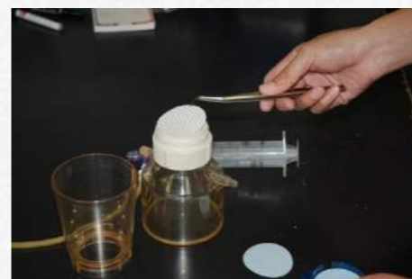
1) ろ過装置にメンブレンフィルターをセット
