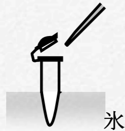
図3-43 1.5 mLマイクロチューブを使って試薬を混合
