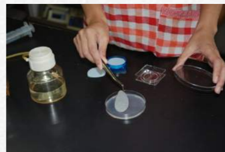
3) メンブレンフィルターを取り出し、表面を下にしてNARM培地に置床
