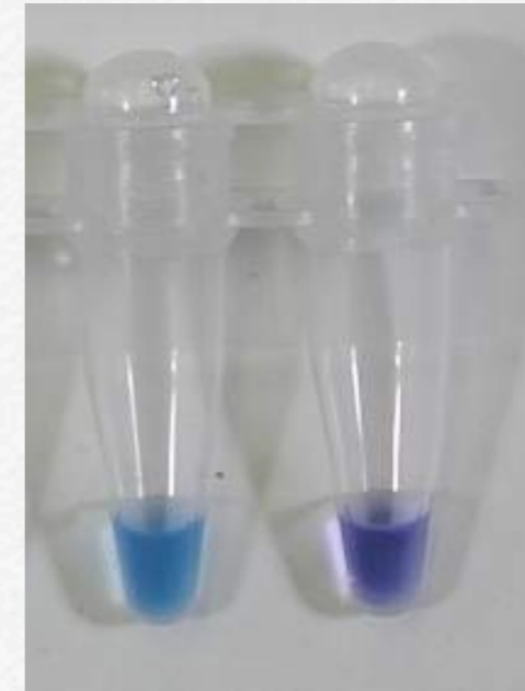
図3-55 HNBの色相による LAMP反応の判定 左が陽性
