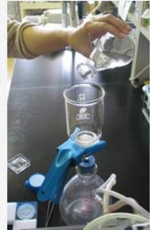
図3-60 メンブレンフィル ターによる集菌
