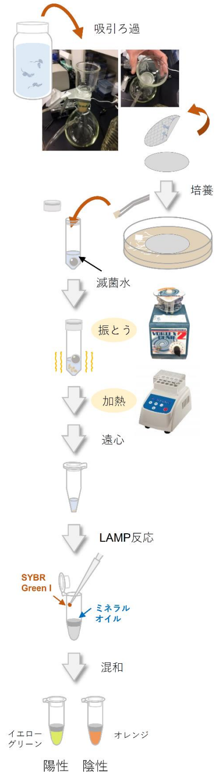
図 4. メンブレン-培養-LAMP による水からの検出
