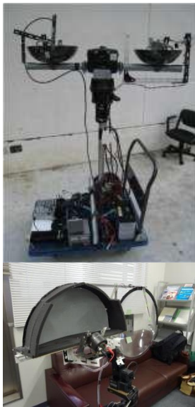
SODAR の開発：音響パルスを発射 して上空の風速を計測する装置 (左上：5号機、左：6号機)
